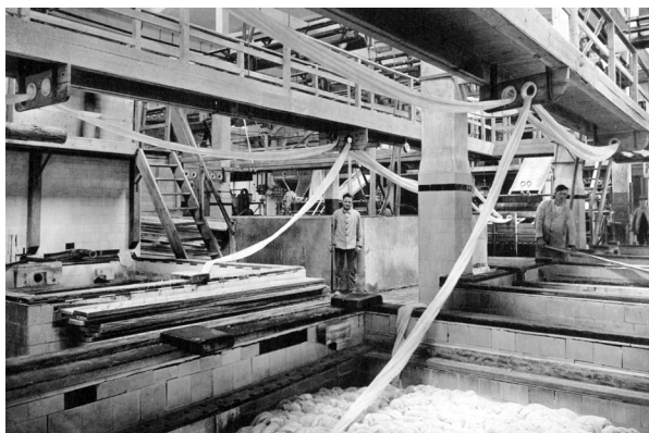
Abb. 24: Mechanische und chemische Baumwollwarenbleiche in der Hermann Windel GmbH (Hans Schmidt, Hundert Jahre Arbeit Hermann Windel GmbH Windelsbleiche, Bielefeld 1933, S. 32)
