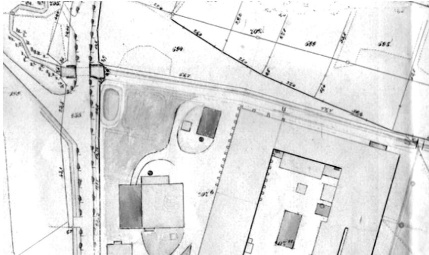
Abb. 9b: Ausschnitt Lageplan ADC, 1877. Das Stauwasser des Petersbachs setzt sich zunächst ab im kanalartigen Becken des Teiches, bevor es abgelassen wird in einer unterirdischen Rohrleitung hin zur Fabrik. An der Erschließungsstraße ist die erste Kläranlage in einfacher Gestalt eines ovalen Teiches zu sehen. Rechts davon der hölzerne Kühlturm. (Quelle: Firmenarchiv Dürninger, Oderwitzer Str. 12 in Herrnhut, Kartenschrank)
