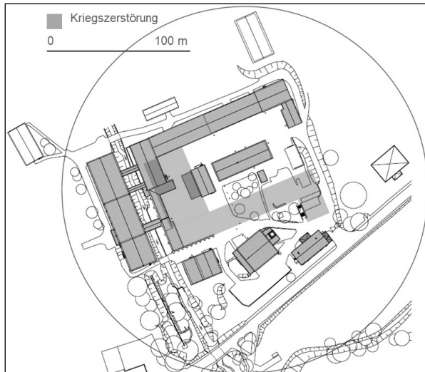
Abb. 13: Draufsicht Fabrikanlage ADC mit Angabe der Kriegsschäden, Stand 2004, Genordet (Quelle: Bauaufnahme Hochschule Zittau/Görlitz 2004)
